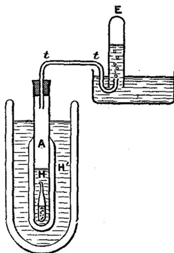
un gaz liquéfié et en mesurant le volume du gaz qui se dégage. On peut faire cette expérience avec du chlorure de méthyle (à  $-21^{\circ}$ ). L'expérience a été faite par MM. Dewar et Curie avec l'oxygène liquide (à  $-180^{\circ}$ )
